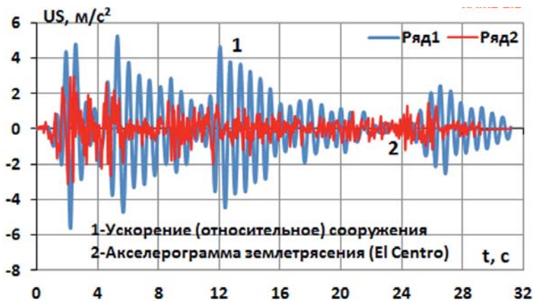
Рис. 5. Относительное ускорение верхней точки сооружения (численное интегрирование) Fig. 5. Relative acceleration of the top point of the structure (numerical integration)
