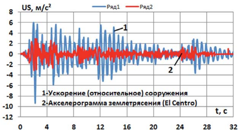
Рис. 4. Относительное ускорение верхней точки сооружения (численное дифференцирование) Fig. 4. Relative acceleration of the top point of the structure (numerical differentiation)
