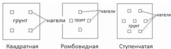
Рис. 2. Конфигурация нагелей при эксперименте
